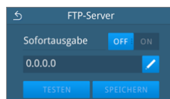
Abbildung 2: FTP-Server Konfiguration am Siegelgerät
