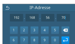
Abbildung 3: Konfiguration IP-Adresse am Siegelgerät
