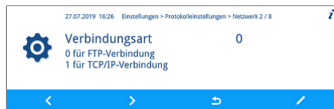
Abbildung 5: Verbindungsart FTP einstellen
